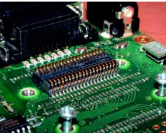
Fot. 4. Producent zastosował w module BT nietypowe złącze
