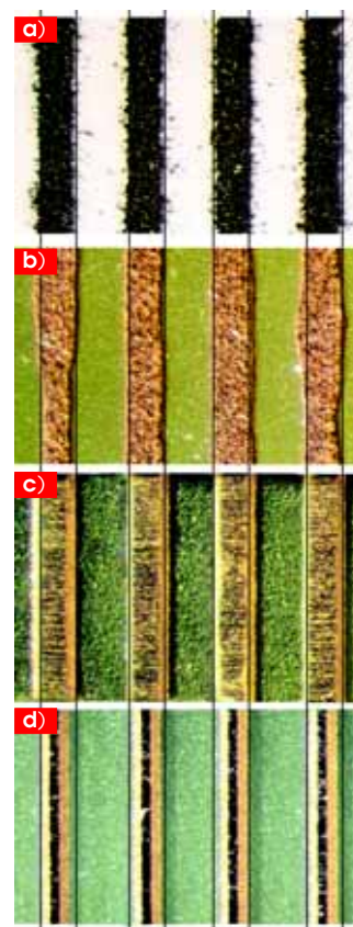
Fot. 16. Ścieżki 6 mils w różnych wykonaniach: wydruk 600 dpi na papierze kredowym (a); termotransfer z papieru kredowego (b); technologia profesjonalna z maską fotopolimerową (c); technologia profesjonalna z maską metaliczną Sn-Pb (d). Wykonania profesjonalne zapewniają znacznie lepszą równomierność ścieżek niż metoda termotransferowa, ale nie bez niespodzianek - w ostatniej próbce (maska SnPb) ze ścieżek o projektowanej szerokości 6 mils zostało zaledwie ok. 2 mils
