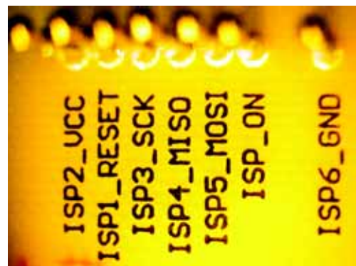
Fot. 23. Złącze ISP na podstawie uruchomieniowej opisane (warstwa Top Overlay ) metodą termotransferową z oderwaniem papieru na gorąco. Wzdłuż górnej krawędzi widoczny zarys sprężystych szpilek testowych produkowanych przez Q&A rozmieszczonych w rastrze 100 mils. Całkowita wysokość znaków wynosi 60 mils
