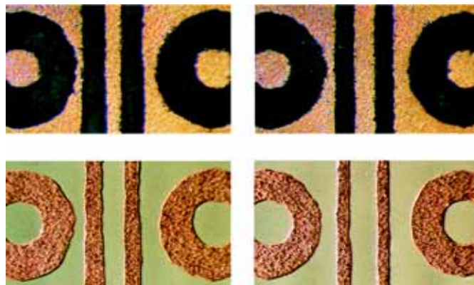
Fot. 10. Krytyczny punkt metody, zależny od nabytej wprawy. Uplastyczniony toner rozlewa się na powierzchni miedzi w stopniu proporcjonalnym do temperatury stolika i nacisku tamponu. Oba fragmenty widoczne na zdjęciu pochodzą z jednej płytki, a finalna różnica szerokości ścieżek zależy wyjątkowo od czasu i siły prasowania
