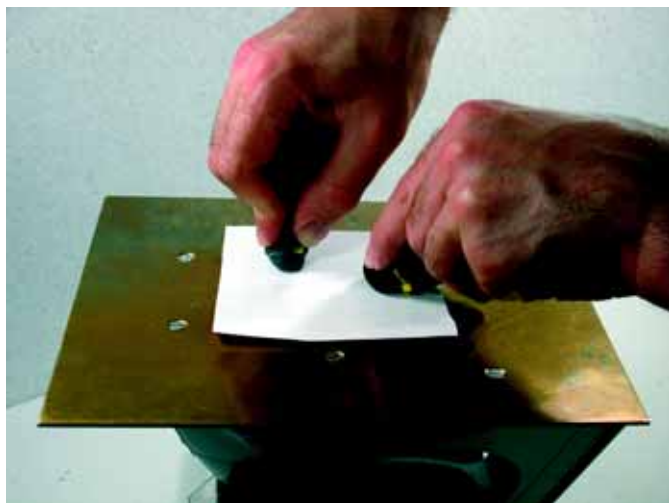
Fot. 9. Najwygodniejszym sposobem prasowania okazało się użycie dwóch, ciasno zwiniętych, szmacianych tamponów. Jednym przytrzymujemy gorącą płytkę, a drugim pocieramy papier miejsce obok miejsca, dociskając toner do powierzchni miedzi
