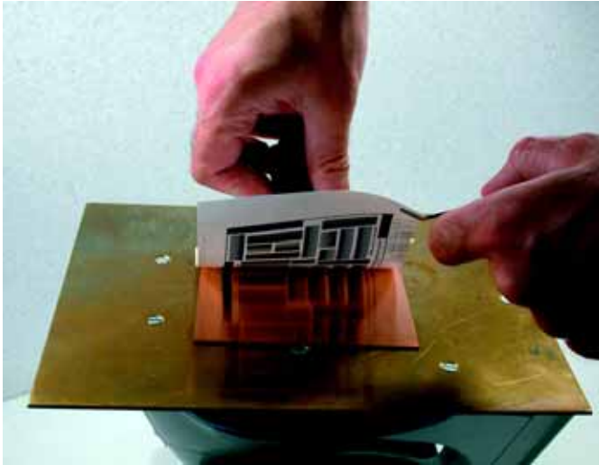
Fot. 8. Przykładanie maski do powierzchni gorącego laminatu. Alternatywnie można przytwierdzić maskę na zimno, skrawkami samoprzylepnego papieru. Należy zwrócić baczną uwagę, aby w pierwszych sekundach nagrzewania nie nastąpiło przesunięcie i rozmazanie przenoszonego obrazu
