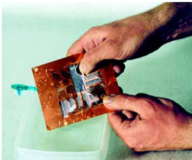
Fot. 13. Do usuwania resztek powłoki kredowej można użyć szczoteczki do zębów, a najlepiej - opuszka własnego palca. Prawidłowo nałożony toner mocno przylega do miedzi i wytrzymuje bez uszkodzenia nawet energiczne pocieranie
