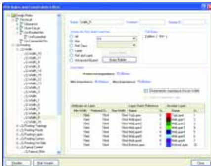
Rys. 5. Widok okna edytora reguł projektowych z wybraną regułą określającą impedancję połączeń dla jednej z sieci
