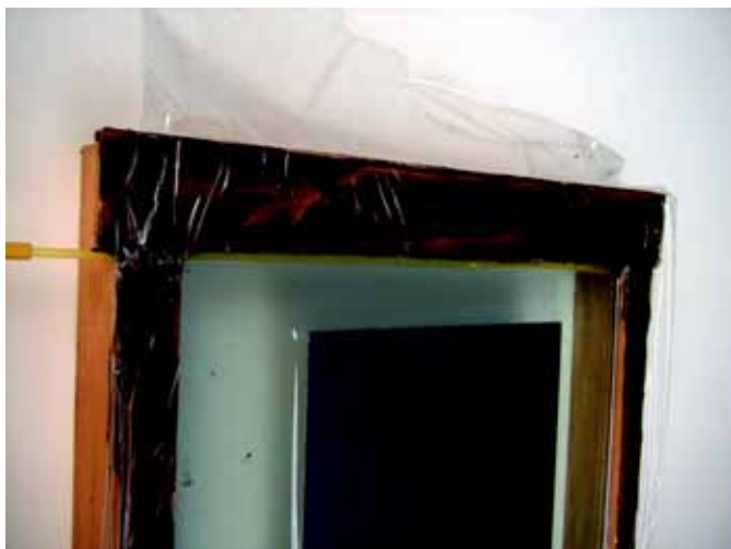
Fot. 3. Podciśnienie dociskające folię można uzyskać dzięki wprowadzeniu pod folię polietylenowej rurki z otworami
