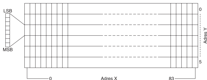
Rys. 5. Organizacja pamięci RAM wyświetlacza
