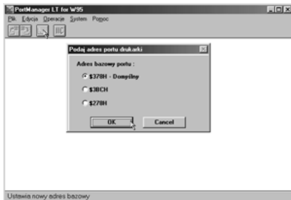
Rys. 4. Przed rozpoczęciem pracy ustawiamy adres bazowy portu równoległego
