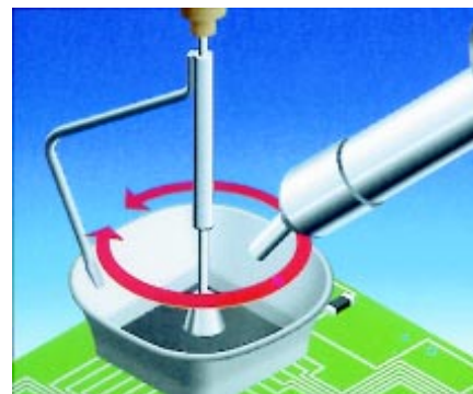
Rys. 8. Lutownice na gorące powietrze mają wymienne dysze dostosowywane do wielkości układu scalonego
