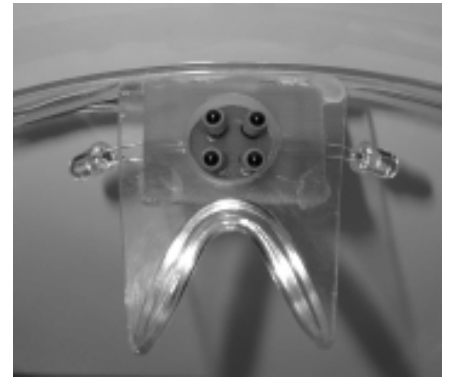
Fot. 5. Umieszczenie fotodetektorów wykrywających położenie głowy
