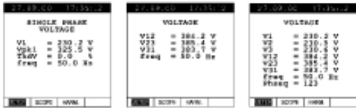
Rys. 3. Widoki ekranów przy pomiarze napięcia w układzie jednofazowym, trójfazowym trójprzewodowym oraz trójfazowym czteroprzewodowym
