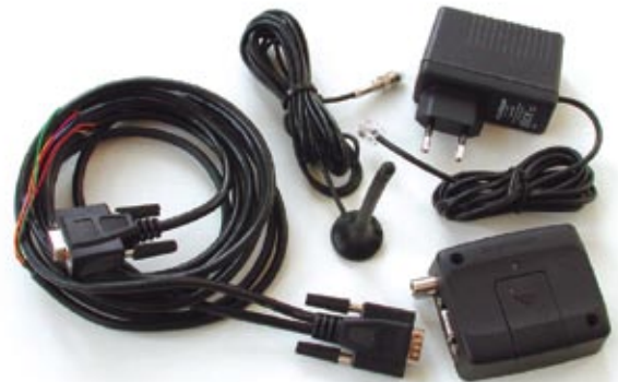
Fot. 1. Zestaw sprzętowy wystarczający do wykonania połączenia TCP/IP
