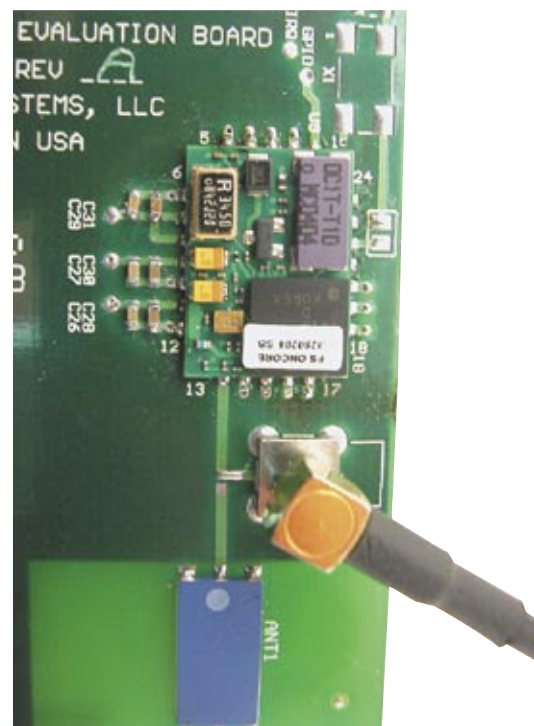
Fot. 1. Wygląd odbiornika M12+ Oncore zamontowanego na płytce bazowej
