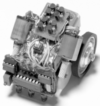
Fot. 2. Diody LED umieszczone w górnej części obudowy sygnalizują stany czujników toru
