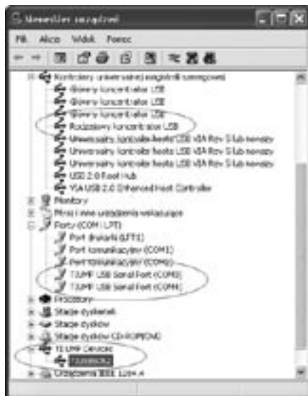
Rys. 10. Okno menedżera urządzeń systemu Windows po zainstalowaniu sterowników TUSB5052
