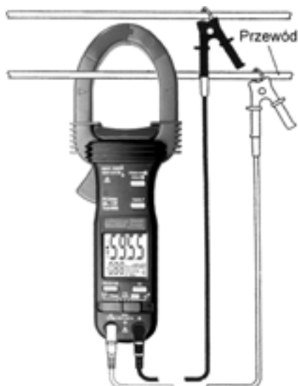
Rys. 2. Sposób podłączenia BM155 podczas pomiaru mocy
