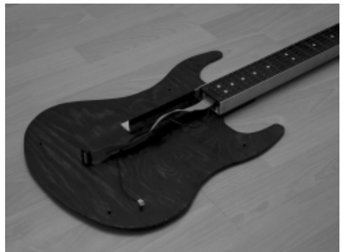
Fot. 3. Podstawa korpusu z zamocowanym gryfem i wzmocnieniem
