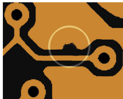
Rys. 14. AOT – Niewielki ubytek w płaszczyźnie masy nie musi dyskwalifikować płytki
