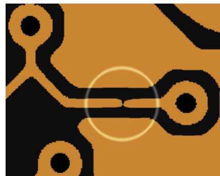
Rys. 13. AOT – Przewężenie ścieżki sygnałowej również zostanie zakwalifikowane jako istotne uszkodzenie
