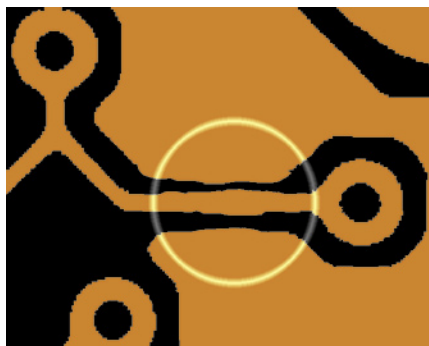
Rys. 12. AOT – Nadmierne zwężenie przerwy izolacyjnej rozpoznawane jako defekt
