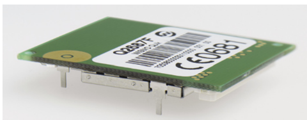
Fot. 1. Wygląd zewnętrzny modułu Q2687
