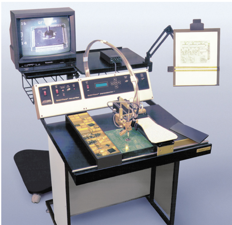
Manipulator do ręcznego układania elementów SMD, APS MPP20/21 z systemem APS MPP-VC do wideo inspekcji
