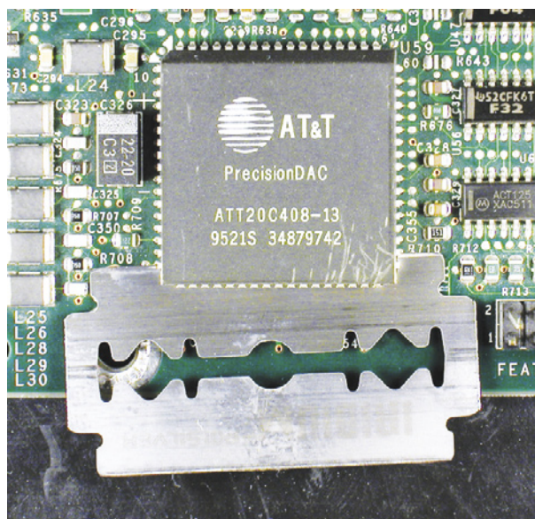
Fot. 75. Demontaż układu PLCC za pomocą żyłетки. Po nagraniu jednej strony układu strumieniem gorącego powietrza wyprowadzenia poddają się na tyle, że można wsunąć pod nie cienkie ostrze
