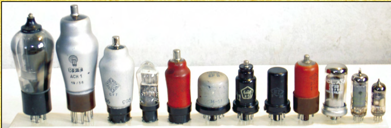
Fot. 9. Lampy odbiorcze różnych rodzajów (od lewej): 1 - lampa o cokole nóżkowym głośnikowa z anodą wyprowadzoną na górze bańki, 2 - lampa o cokole nóżkowym głośnikowa z siatką wyprowadzoną na górze bańki, 3 - lampa o cokole bocznostykowym 8 nóżkowa, 4 - lampa o cokole bocznostykowym 5 nóżkowa (lampa prostownicza, dioda w. cz.); 5 - lampa o cokole bocznostykowym serii czerwonej, 6 - lampa serii stalowej w wykonaniu szklanym, 7 - lampa o cokole oktalowym (stalowa) z siatką wyprowadzoną na górze, 8 - lampa o cokole oktalowym (stalowa) z siatką wyprowadzoną w cokole, 9 - lampa o cokole oktalowym (szklana) z siatką wyprowadzoną na górze, 10 - lampa o cokole loktalowym, 11 - lampa o cokole nowalowym, 12 - lampa o cokole heptalowym
