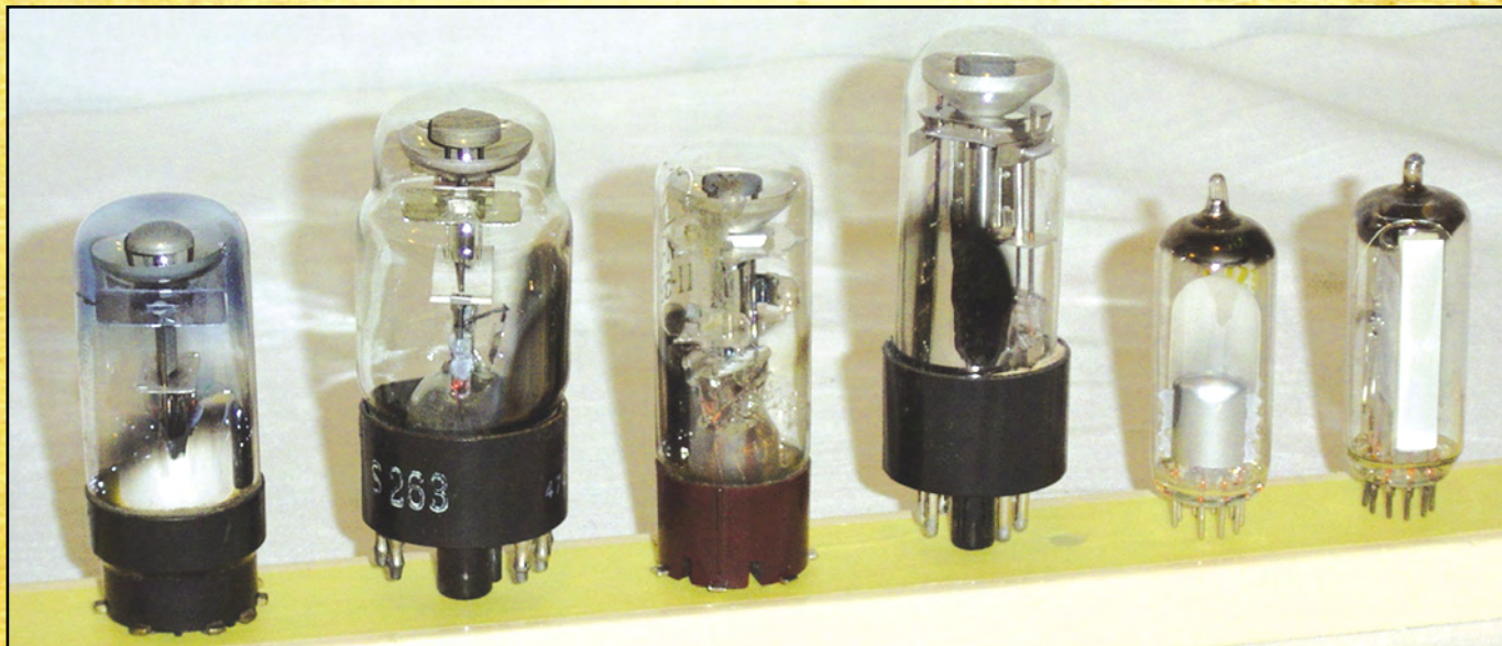
Fot. 10. Wskaźniki strojenia – oka magiczne (od lewej): 1 - EM2, 2 - EM11, 3 - EM4, 4 - 6E5C ( produkcja ZSRR), 5 - EM80, 6 - EM84
