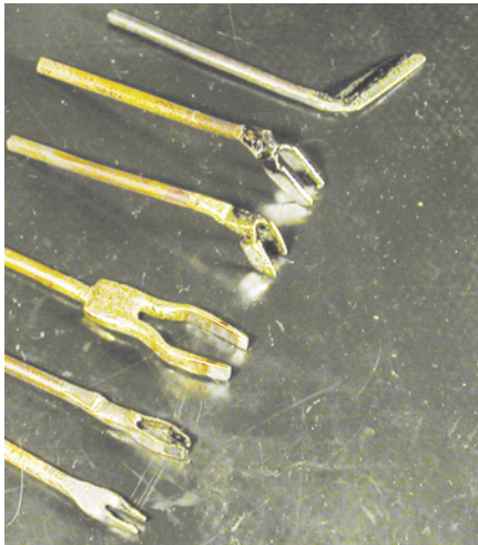
Fot. 68. Wykonany doraźnie zestaw grotów kształtowych do zwykłej, grzałkowej lutownicy 40W. Od góry: „pletwa” do jednoczesnego nagrzewania całego rzędu wyprowadzeń układu scalonego, dwa rodzaje grotów pasujące układów SOIC, widełki do demontażu kondensatorów tantalowych (lutowane twardym stopem), widełki do usuwania 1206 i SOT23, j.w. ale dla rozmiaru 0805
