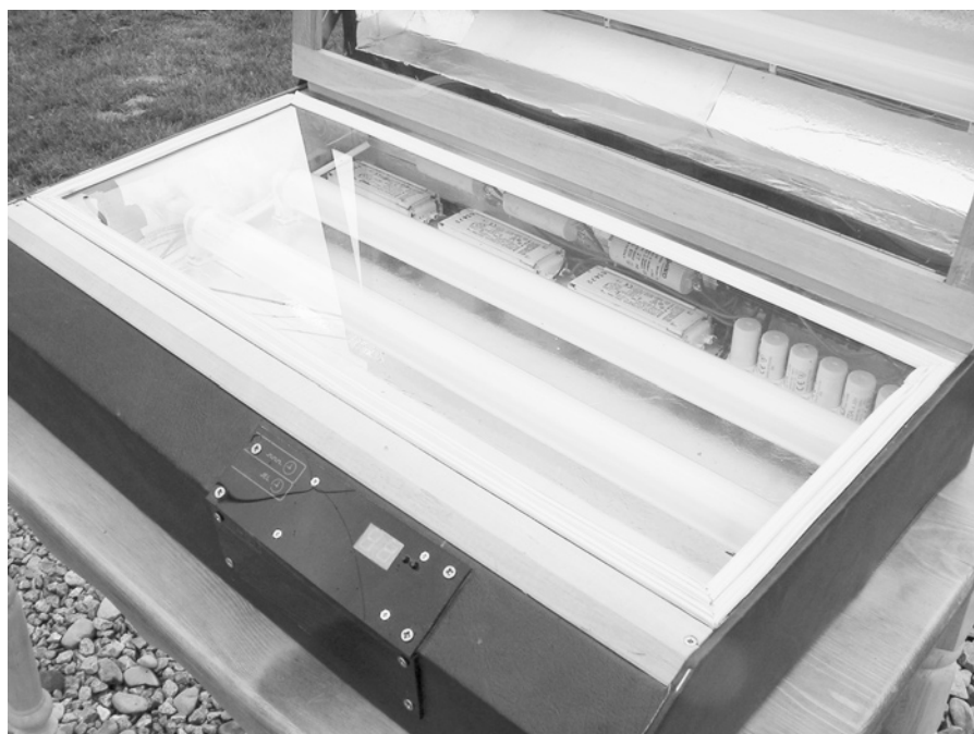
Fot. 6. Mocowanie szyby ułatwia dodatkowa uszczelka
