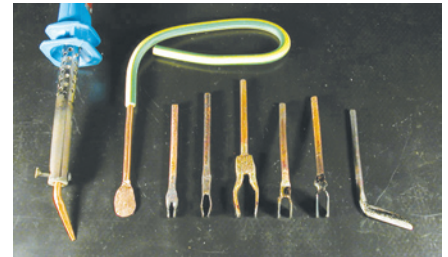
Fot. 55. Wykute na poczekaniu groty kształtowe do lutownicy mogą bardzo ułatwić demontaż SMD
