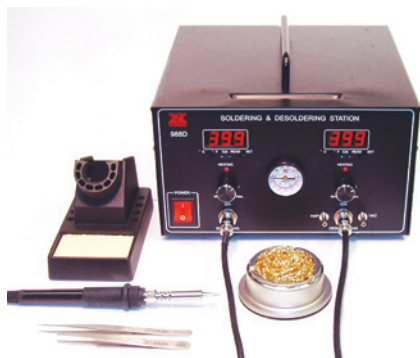
Fot. 51. Stacja lutownicza Xytronic 988D z końcówką lutowniczą ES-D107
