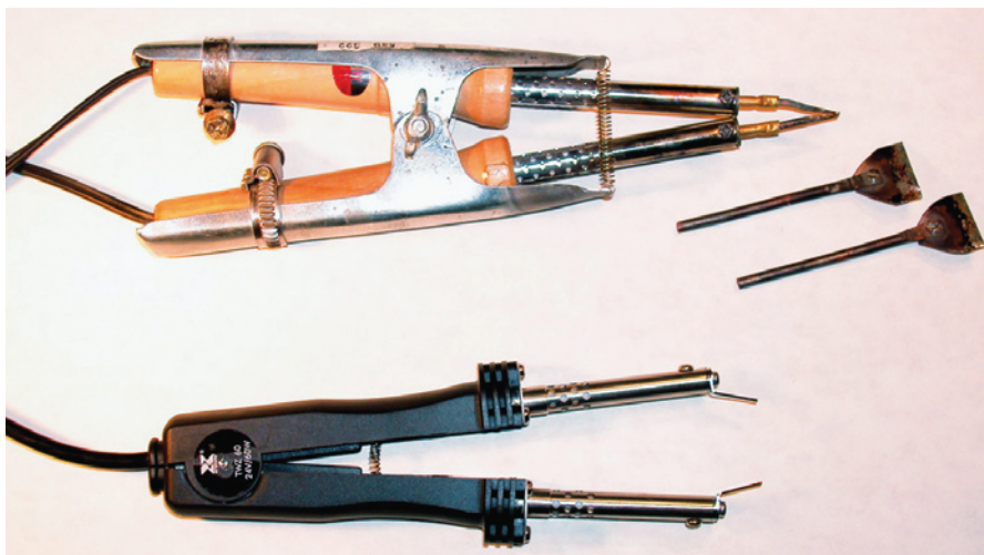
Fot. 54. Dwie termopincety do demontażu elementów SMD: (D) TWZ-60 z wyposażenia stacji XY-988D oraz (G) prosta konstrukcja amatorska
