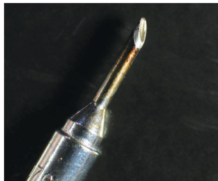
Fot. 52. Grot „miniflala” do montażu układów scalonych o gęstym rastrze wyprowadzeń
