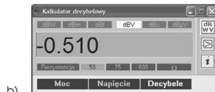
Rys. 4. Główne okno programu „Kalkulator decybelowy” – pokazano przeliczenie wartości wyrażonej w dBm (a) na dBV (b)
