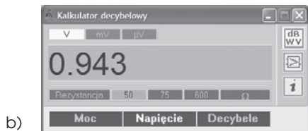
Rys. 5. Wynik konwersji poziomu mocy 12,5 dBm na odpowiadającą mu bezwzględną wartość mocy (17,783 mW) lub napięcia (0,943 V)
