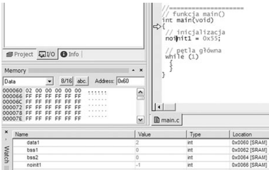
Rys. 9. Zmienne inicjalizowane w AvrStudio
