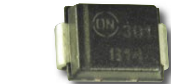
Fot. 20. Dioda w obudowie DO-214AA (SMB)
