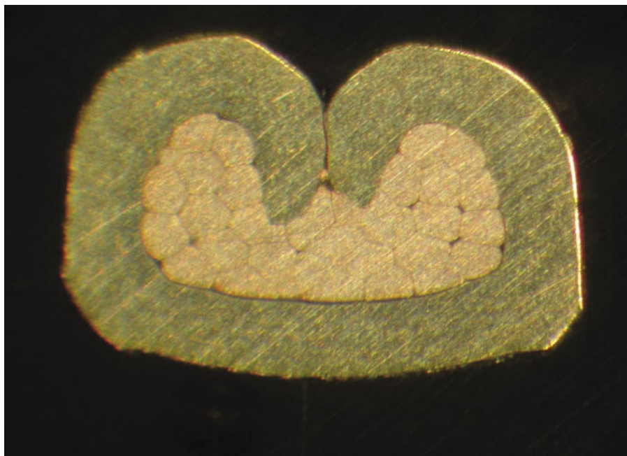
Fot. 1. Przekrój poprawnie zaciśniętego konektora
