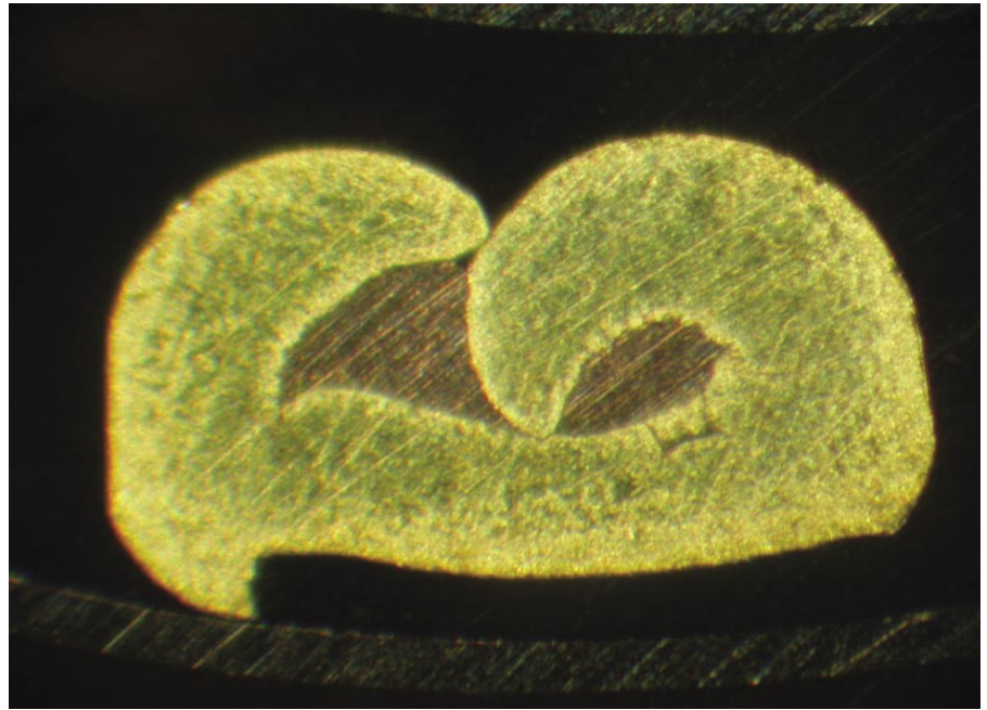
Fot. 2. Konektor źle zaciśnięty
