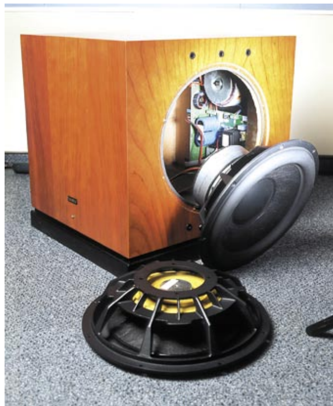
Fot. 93. Subwoofer Avance Signature Sub10, z głośnikiem XLS12 i membraną bierną (jej miejsce znajduje się po drugiej stronie obudowy).
