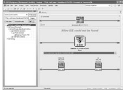
Rys. 5. Widok Devices po podłączeniu płyty uruchomieniowej NanoBoard NB-1, wyposażonej w moduł FPGA Xilinx Spartan IIE.
