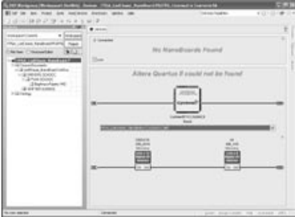
Rys. 4. Widok Devices po podłączeniu płyty ewaluacyjnej z układem FPGA Altera Cyclone z zestawu LiveDesign Evaluation.
