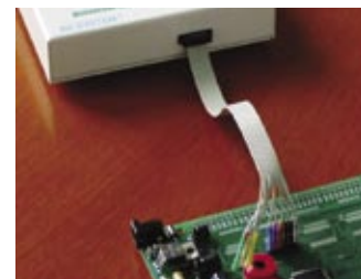
Fot. 4. Programatory Uprog wyposażono w złącze do programowania ISP
