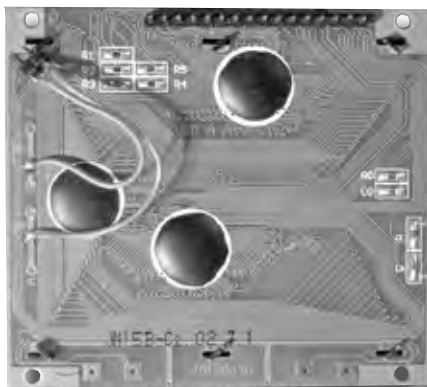
Fot. 2. Wyświetlacz JM12864A z zamontowanym złączem i przewodami do podświetlenia
