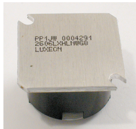
Fot. 4. Widok aluminiowego radiatora, w jaki wyposażono diody z serii Luxeon I
