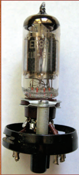
Fot. 32. Widok cokołu przejściowego przy zamianie lampy EF13 na EF89
