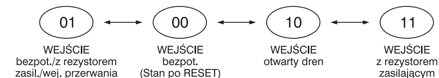
Rys. 3. Poprawne zmiany trybów pracy portów IO
