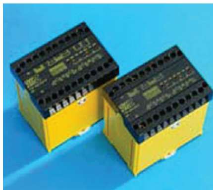
Fot. 3. Moduł szacujący współpracujący z czujnikami nacisku
