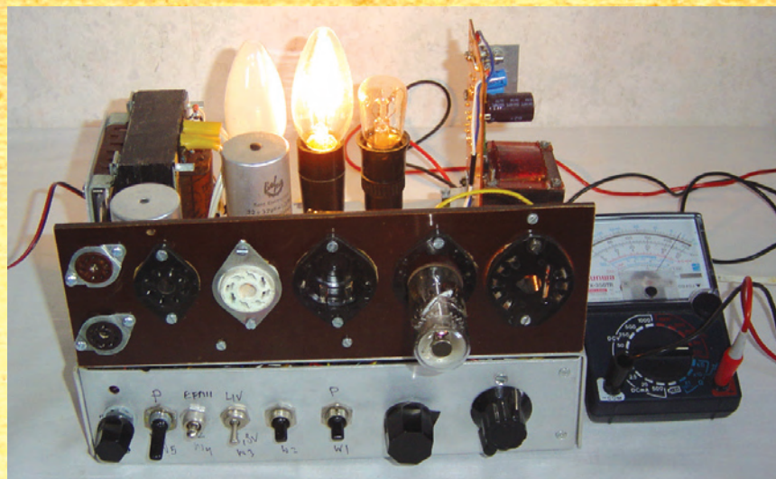
Fot. 23. Przyrząd do regeneracji m.in. elektronowego wskaźnika dostrojenia (oka magicznego)
