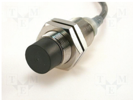
Fot. 5. Czujniki z wysuniętym czółem charakteryzują się znacznie większą strefą działania niż czujniki o tej samej średnicy, ale z czółem zabudowanym. Stosując czujniki z odsłoniętym czółem należy jednak pamiętać, że są one bardziej podatne na uszkodzenia mechaniczne i zakłócenia boczne od znajdujących się wokół nich elementów metalowych. Ilustracja pochodzi z katalogu online firmy TME ( www.tme.pl )
