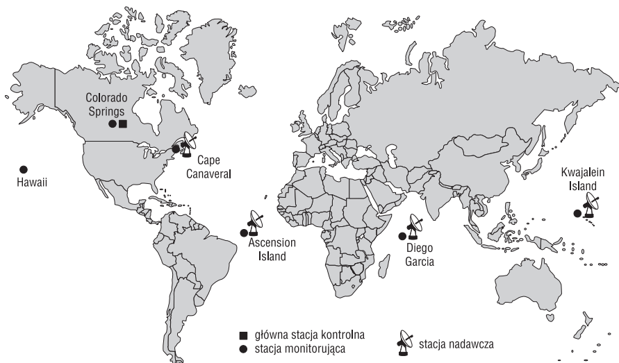
Rys. 8. Rozmieszczenie elementów segmentu kontrolnego systemu NAVSTAR GPS
