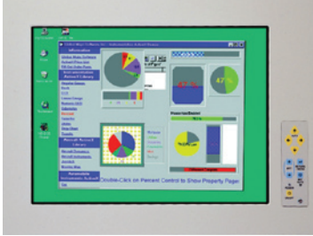
Fot. 4. SRM-150AW – monitor LCD 15” – sun readable – o jasności 1750 cd/m 2 , z aluminiowym panelem, ekranem dotykowym, bryzgoszczelny, z automatyczną regulacją jasności
