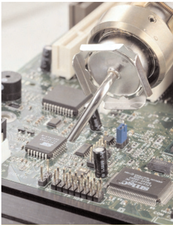
Demontaż układu SMD
