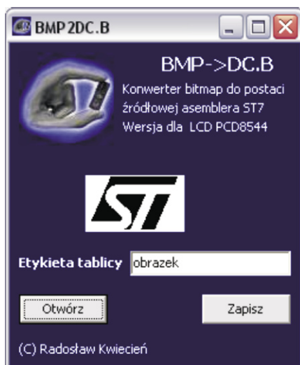
Rys. 4. Winiętka programu służącego do konwersji bitmapy z pliku *.bmp na postać źródłową asemblera ST7
