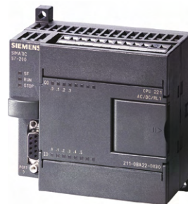
Jednostka centralna z serii S7-200 (CPU221)
