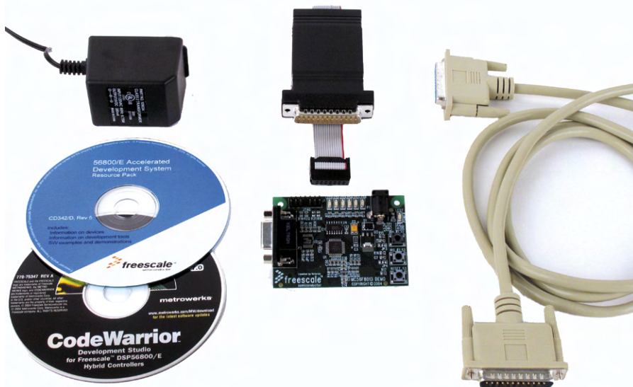
Fot. 2. Płytką demonstracyjną układu 56F8013/14 z interfejsem JTAG/EOnCE (CD zawiera CodeWarriora i dokumentację)
