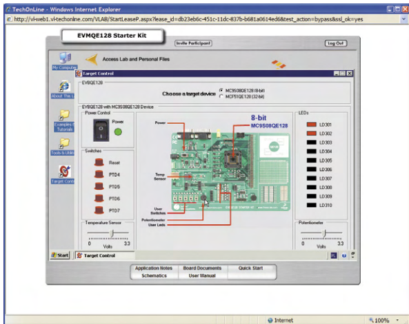
Rys. 3. Okno internetowego symulatora zestawu z mikrokontrolerem MC9S08QE128
