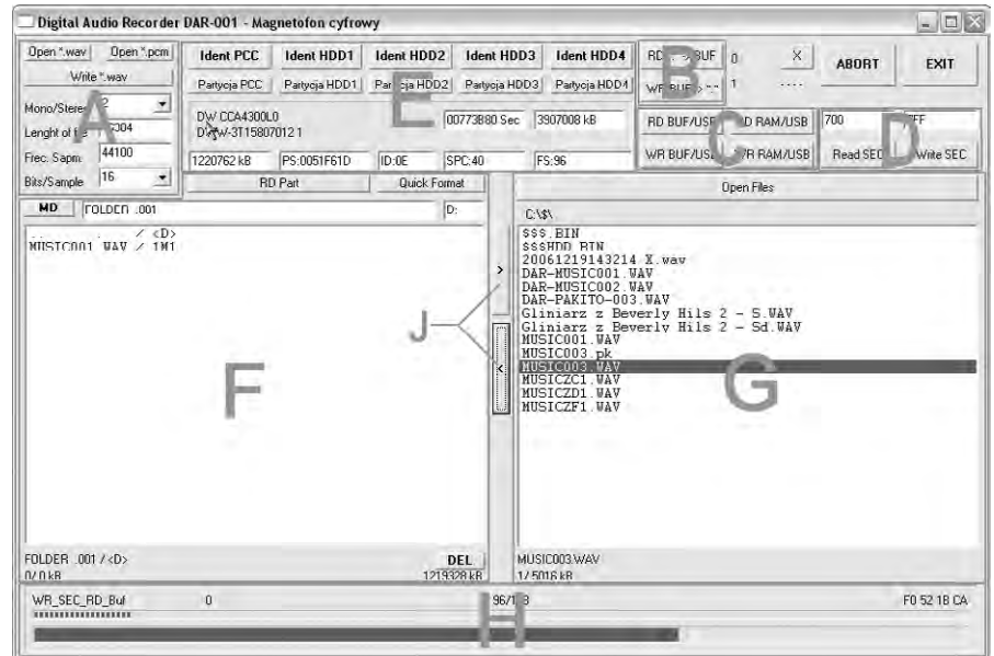
Rys. 12. Okno programu służącego do wymiany plików między magnetofonem a komputerem
