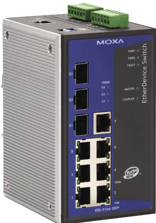
Fot. 4. Zarządzalny switch EDS-510A, który poza standardowymi portami Ethernet 10/100BaseT(X) wyposażono w gigabitowe porty SFP/mini-GBIC (wymienne interfejsy do sieci światłowodowych)
