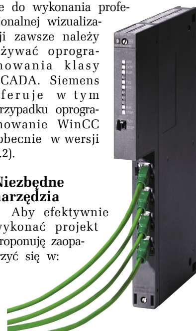
Fot. 2. Procesor CP443-1 Advanced
