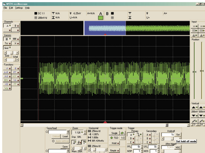
Rys. 4. Działania funkcji „Hold-off”
