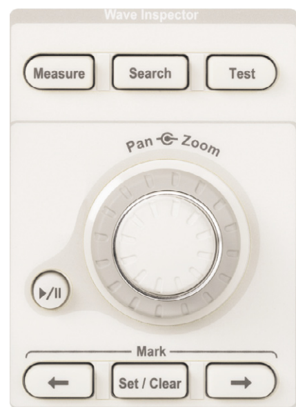
Rys. 1. Wave Inspector – narzędzie do wydajnego zarejestrowanych przebiegów
